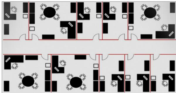
Le coût spatial est un facteur de calcul substantiel pour les entreprises. En aménageant cette plateforme avec des cloisons "Sol-Plafond" il est possible de créer 14 postes de travail au maximum.
